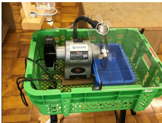
自作した岩石切断機
